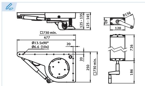
**Equipo hidráulico de elevación y desplazamiento**
