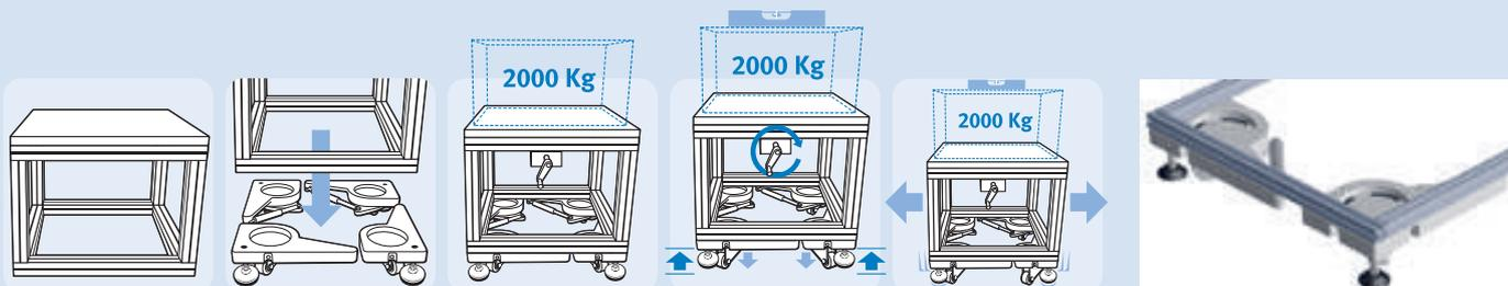
\* Las cuatro bases admiten una carga máxima de 2.000Kg, siempre que estén posicionadas de forma centrada dentro de la estructura destinada a soportar la máquina o equipo.
